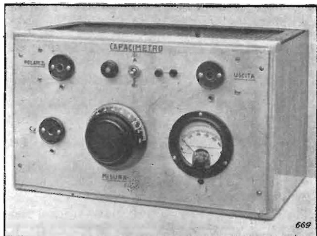
Fig. 5 — Aspetto del capacimetro BS1 attuato presso I.N.E.A.
